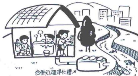
合併処理浄化槽は、し尿と台所、風呂、洗濯排水などの生活雑排水を一緒に処理する高性能の浄化槽です。
