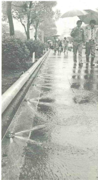
4月18日・路面散水実験装置が完成
