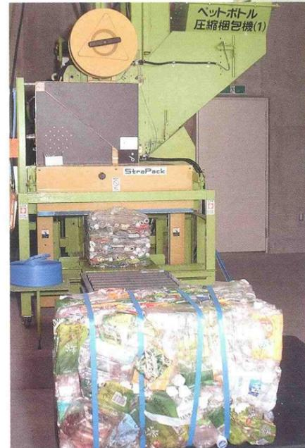
本館1階のペットボトル圧縮梱包機。3階で選別されたペットボトルを成形品にするもので2台備えられている
