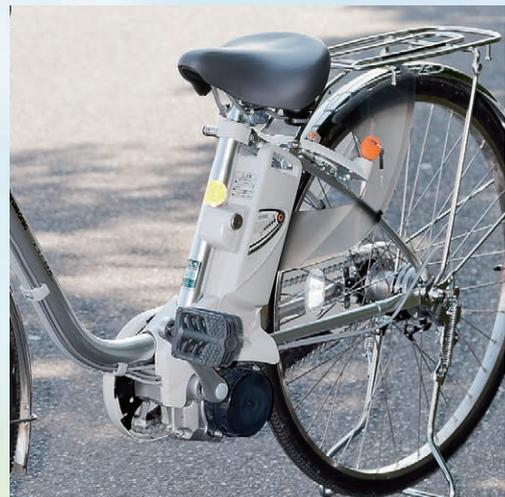
電動モーターユニットはペダルの付け根部分に搭載されていることが多い。
