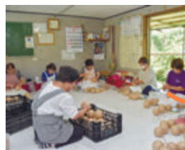
玉皮に一枚ずつクラフト紙を貼り付けていきます
